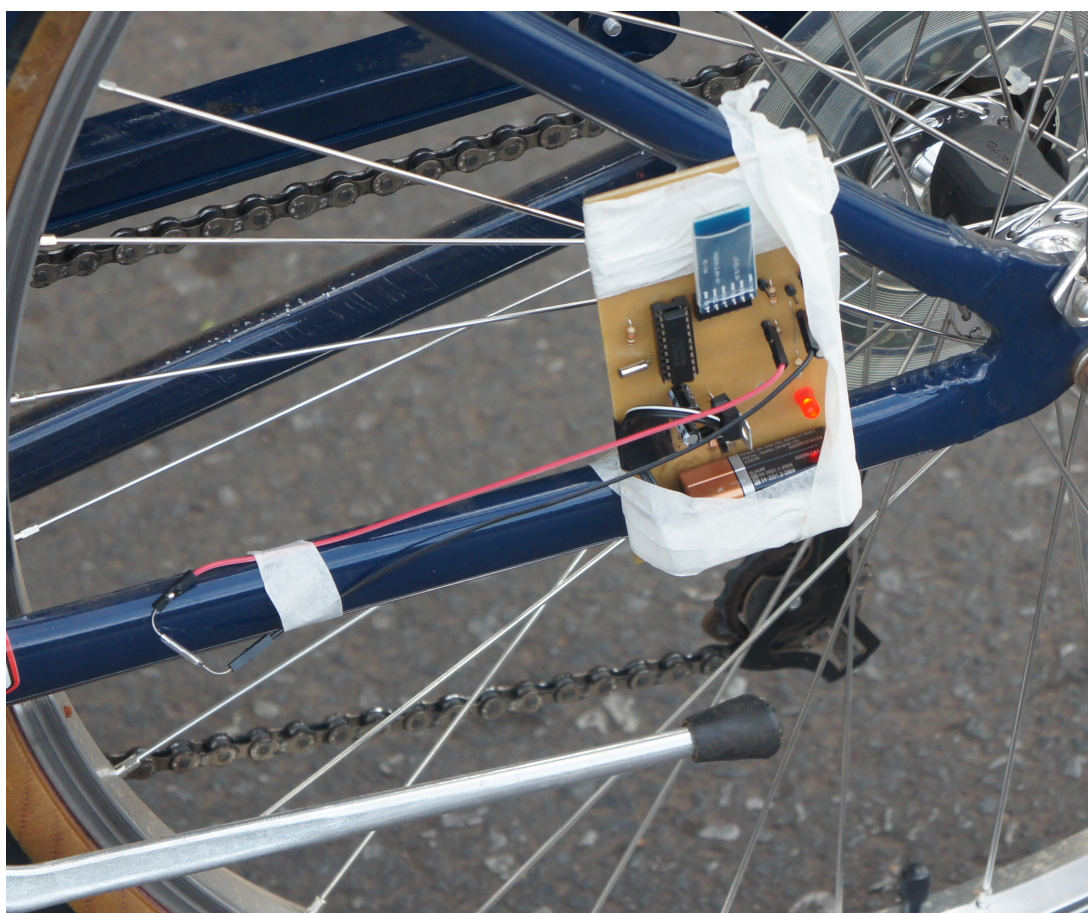
Figura 5.11: Sistema embarcado fixado na bicicleta para medir a cadência
