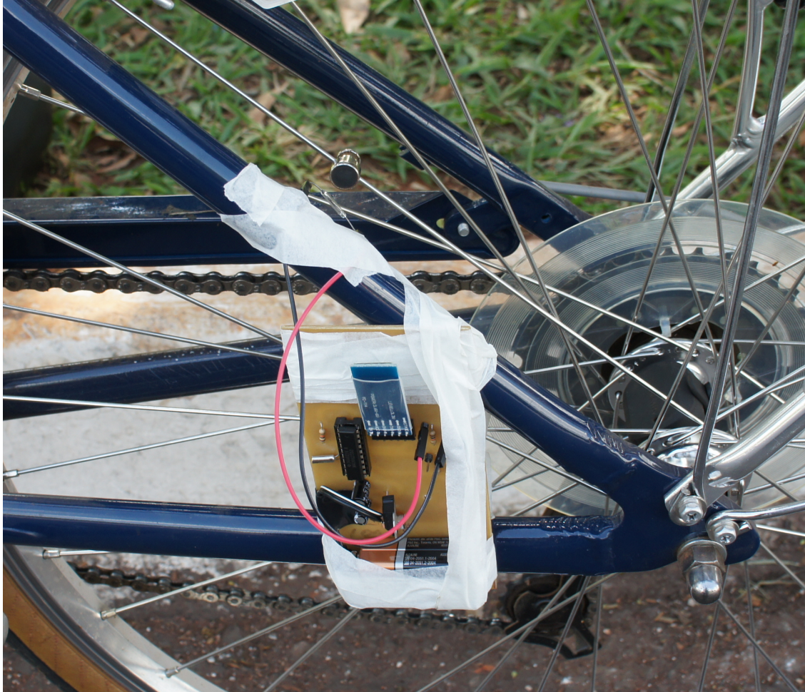
Figura 5.10: Sistema embarcado fixado na bicicleta para medir a velocidade
