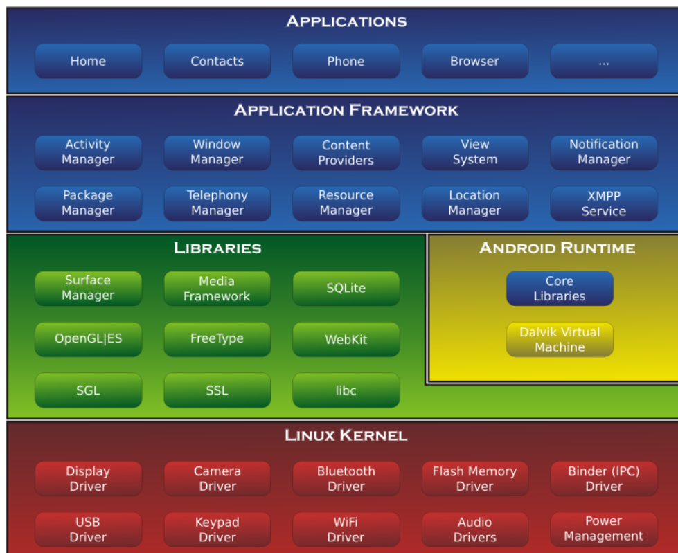
Figura 2.4: Arquitetura do sistema operacional Android. Fonte: [14]
