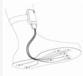
Na figura anterior pode observar-se uma plataforma podobarométrica (A), um sistema de palmilhas transdutoras de pressão plantar (B) e um sistema ambulatório de registo de parâmetros cinemáticos gerais da marcha e da pressão em pontos customizáveis da superfície plantar do pé (C), neste caso um produto Português (*WalkinSense*), com origem na Universidade do Porto.
