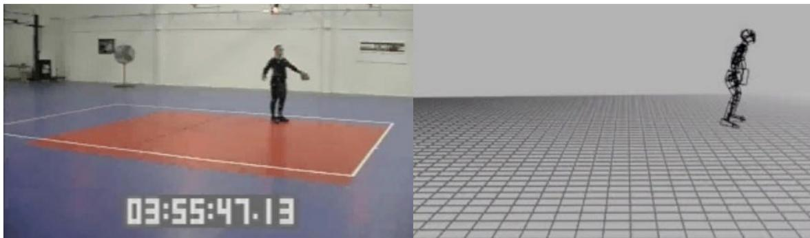
Os dispositivos de aquisição automática de coordenadas proporcionam uma vantagem inigualável, que decorre do facto de suprimirem o muito elevado tempo de digitalização, ponto a ponto, que caracterizava as metodologias precedentes. Hoje é possível, portanto, adquirir o modelo numérico descritivo do movimento real em tempo igualmente real, sem necessidade de recurso a um pós-processamento de cada imagem extremamente moroso e fastidioso, inclusivamente em ambiente subaquático.
