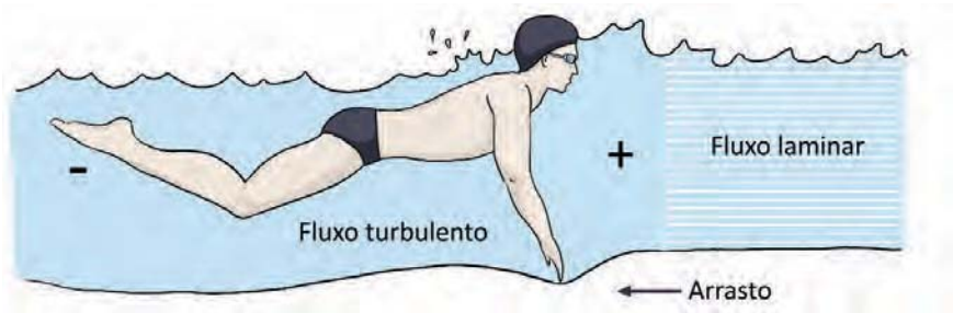
Figura 17. Representação dos gradientes de pressão criados pelo nadador durante o deslocamento
